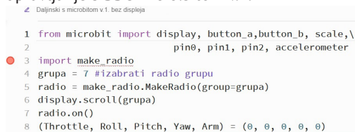
Slika 43.3. Prvi dio programa za daljinsko upravljanje s BBC micro:bitom v.1. gdje valja izabrati grupu 7 (linija 4) jer je na toj grupi ugođen radio drona
