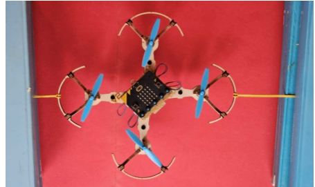
Slika 45.7. Nekoliko knjiga i par gumica omogućit će testiranje bez lomova
