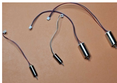
Slika 45.1. Elektromotori bez feritne jezgre od 7 mm i 10 mm
