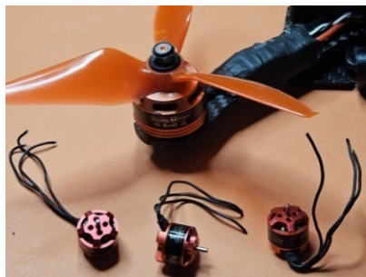
Slika 45.2. Elektromotori bez četkica i kolektora
