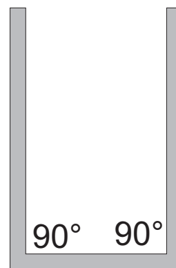
Detalj savijanja: -ugrijati i saviti pod kutem 90°
