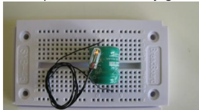
Slika 2. Fotografija prikazuje pražnjenje NiMH baterije preko žaruljice. Neka pražnjenje traje 15 – 20 minuta.
