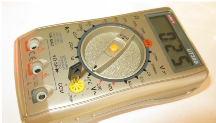
Slika 6. Fotografija prikazuje način mjerenja pojačanja tranzistora BD135.
