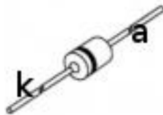
Slika 4. Zenerova dioda je polarizirana. Katoda je na tijelu diode obilježena crnim prstenom.
