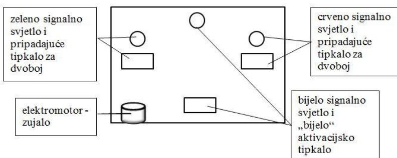
Pažljivo pročitaj cijeli zadatak, a tek potom pristupi izradi. Sastavi tri stalaka za žaruljice. Na prvi stalak montiraj bijelu, na drugi zelenu, a na treći stalak crvenu signalnu žaruljicu. Montiraj stalke na podlogu, a podlogu postavi na stol. Uz njih montiraj pripadajuća tipkala. Na vratilo elektromotora zalijepi komadić trake za izoliranje kako bi proizvodio zvuk (zujao) dok je elektromotor uključen. I zujalo montiraj na podlogu ili stalak.
